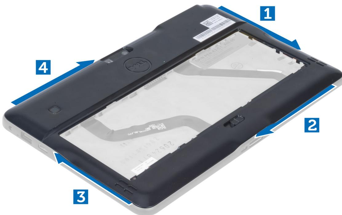
5. Fare leva e sollevare le linguette che assicurano il coperchio della base area di alloggiamento della batteria verso l'alto.
